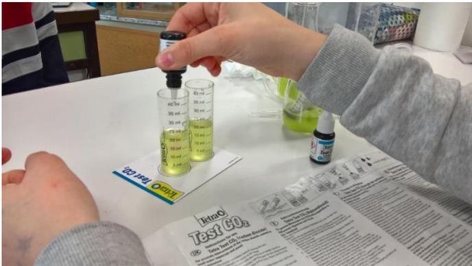
Test 2 : Détermination de la teneur en CO<sub>2</sub> en utilisant un tableau de correspondance à partir des mesures PH/KH
